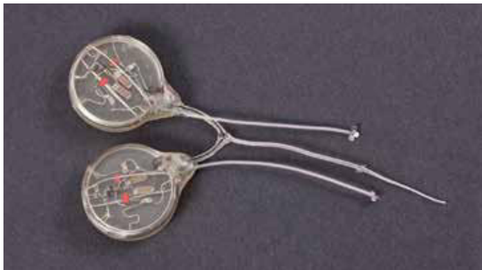
Das Med-El-4-Kanal-Implantat von 1978, das zur simultanen Stimulation verwendet wurde Foto: Med-El Medical Electronics
